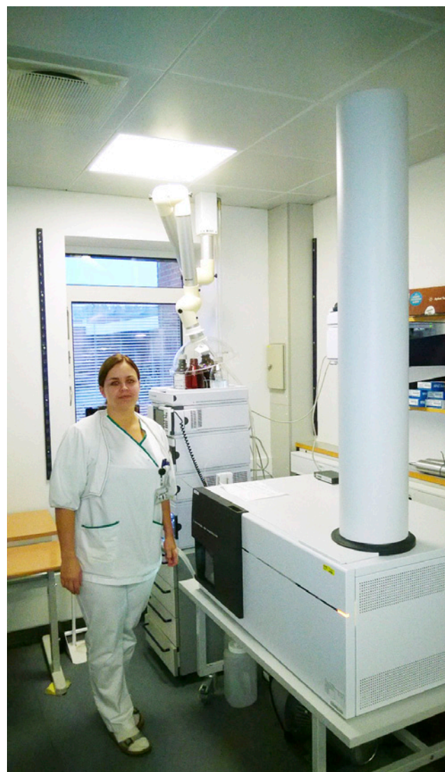
Apparaturansvarlig bioanalytiker Anne Carlsen James ved Aarhus Universitetshospitals nye Q-TOF fra Agilent. Flight-tuben er 1,4 m høj.
