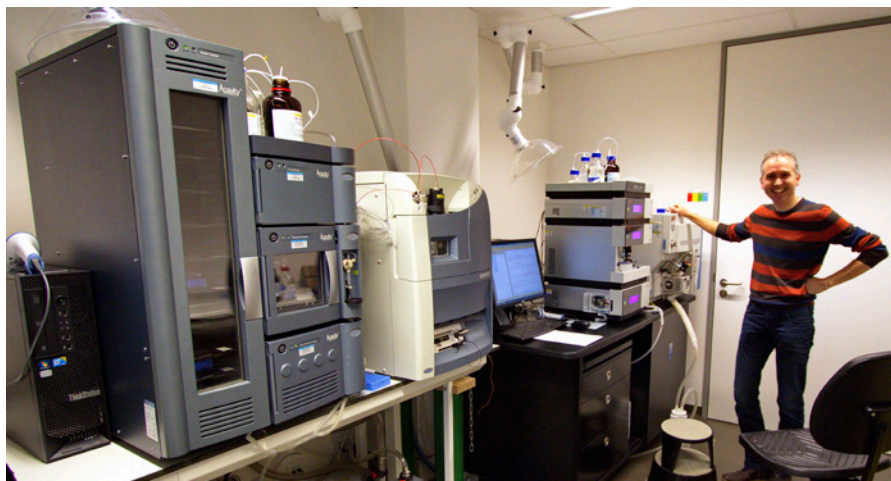
Forskningskemiker Bart van der Nagel fremviser LC-MS/MS apparatur på Laboratorium Apotheek, Erasmus MC, Rotterdam. Apparatet bruges til klinisk toksikologi, herunder analyser af B-Phosphatidylethanol.
