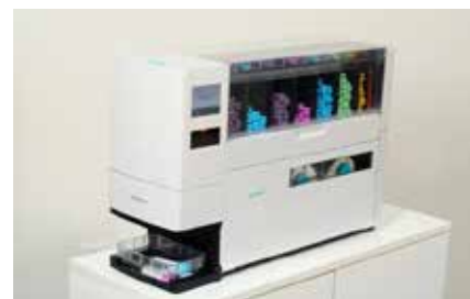
Figur 2: Udstyr til automatisk mærkning af prøverør
